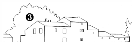
3 Adjonctions contiguës, diversifiées, décroissantes... aménagement global dans le temps, de cours, passages et terrasses internes à l'ensemble
